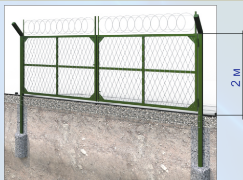
Общий вид Ворот распашных «Топаз» ВР 2000x6000. Вариант исполнения № 4. ВР 2000x6000/60x40x2/ПКЛЗ 150x334/ СТ Б 140x140x5, 4550/ТО-Н/ ОЦс НН
