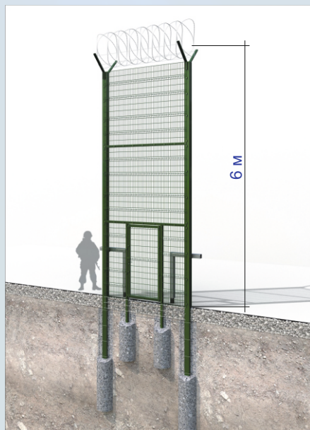
Общий вид встроенной Калитки «Топаз» К 2000x1000/60x40x2/ ПС50x150x5/ СТ Б 60x60x2, 3465/ТО-НП/ОЦ с НН
